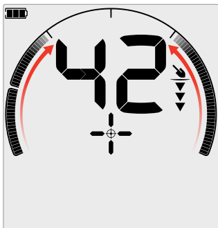
Signal cible faible/excentré: Moins de segments de discrimination sont activés. La cible est située plus près de l'extérieur de la bobine.
